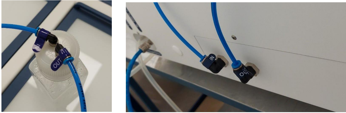
Figura 23.1 Conexión del tubo a la botella de humidificación y a la incubadora multicámara FIV MIRI® Humidity
